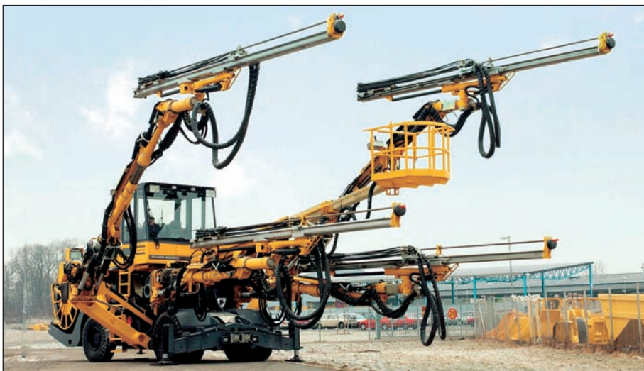
■ Jumbo de perforación de 4 brazos (Atlas Copco).
