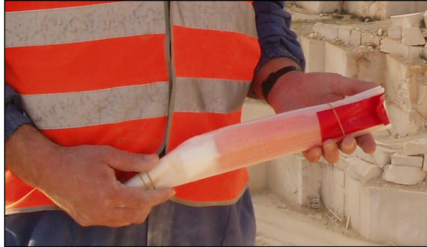
Figura 7. Bolsa Autoinflable previa a su activación. Obsérvese el reactivo de color rojo que produce un gas inerte en contacto con el reactivo sólido de color blanco anejo.
