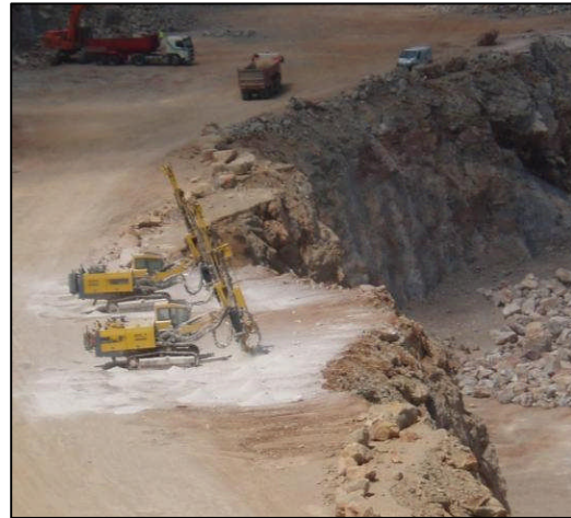
Figura 1: Ejemplo de planificación de voladuras para conseguir geometrías repetitivas con doble cara libre (esquina superior izquierda) que será por defecto el punto de inicio de la voladura
