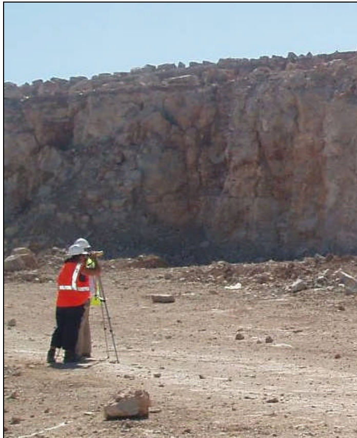
Figura 2: Perfilometría 2D de cada barreno del frente de voladura
